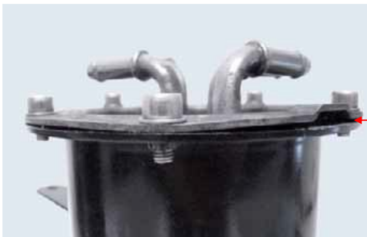
Alojamiento y tapa de filtro KX178D deformados por una apertura/cierre incorrecta.
