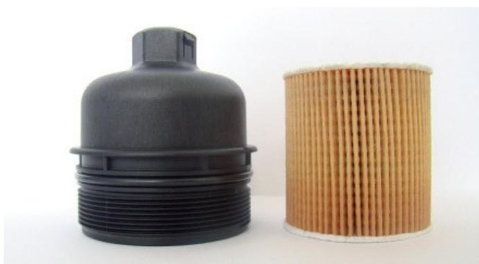
Figura 1: Tapa y elemento filtrante
